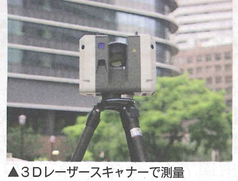
▲3Dレーザースキャナーで測量
