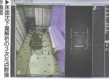
▶床面沈下量解析の3次元点群画像
